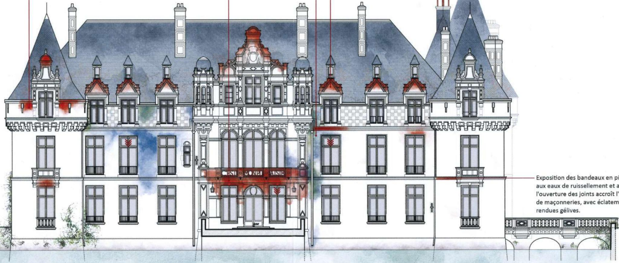
Exposition des bandeaux en pierre de taille aux eaux de ruissellement et aux intempéries : l'ouverture des joints accroît l'humidité en cœur de maçonneries, avec éclatements des pierres rendues gélives.
